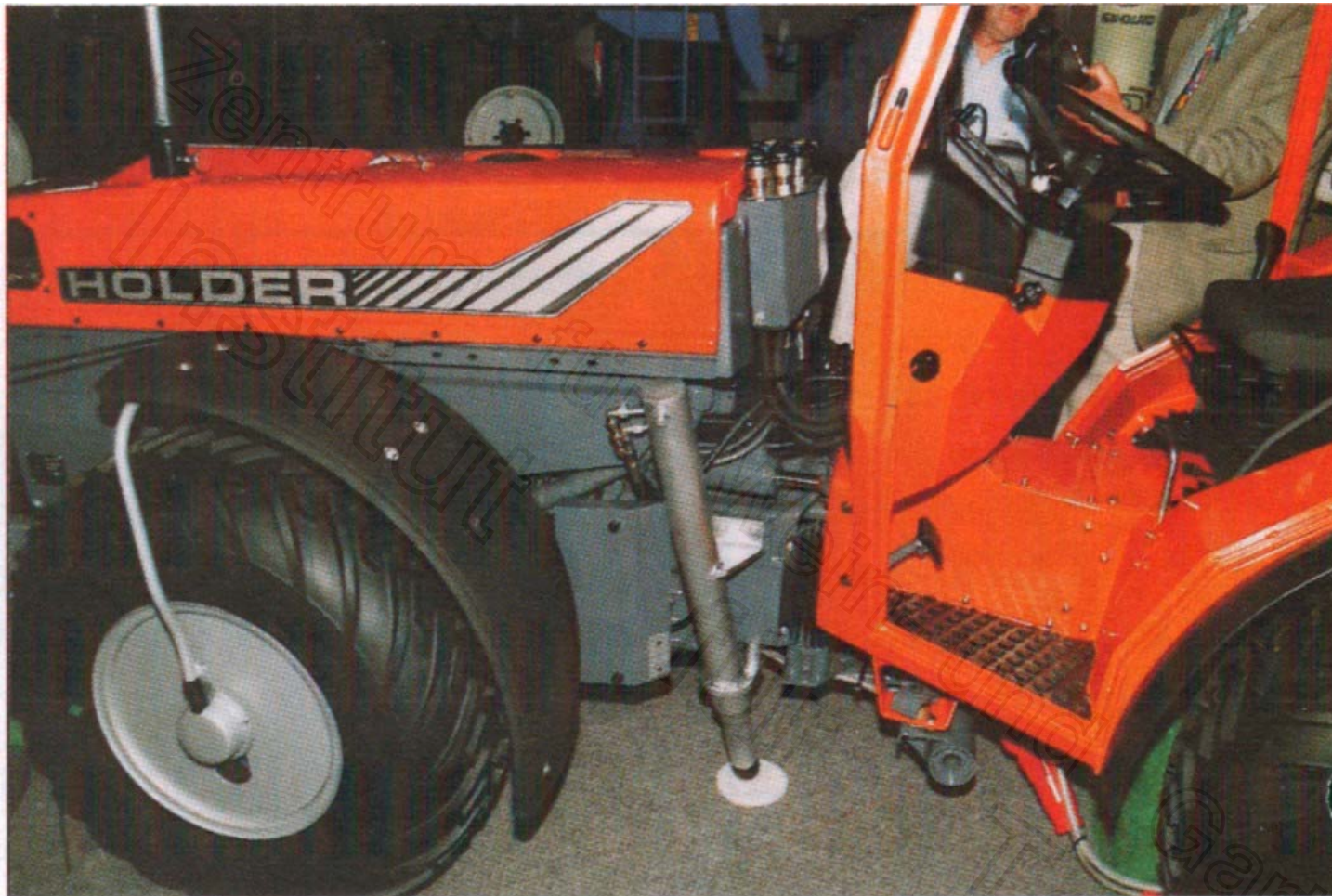
▲ Abb. 1: Die Reifendruck-Regelanlage von Holder gestattet, den Luftdruck während der Fahrt von Niederdruck im Weinberg auf höheren Druck für Straßenfahrt zu verstellen (Fotos: Link/Ostarhild)
